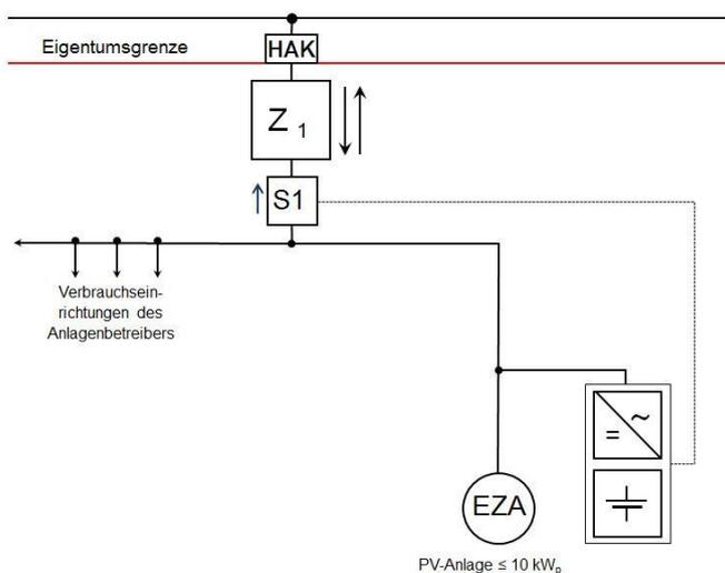
Abbildung 4-Speichersystem im Erzeugungspfad, EZA (PV) kleiner 10 kW<sub>p</sub>
