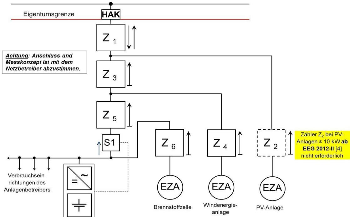
Abbildung 9 -Komplexes Anschlussbeispiel mit mehreren EZA und einem Speichersystem in der Kundenanlage
